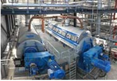
Zwei HUBER Scheibentrockner RotaDry® 2050 M kommen in der Klärschlammmonoverbrennungsanlage (KVA) Hannover-Lahe künftig als Vortrockner zur Brennstoffaufbereitung des Klärschlammes zum Einsatz. Die umweltfreundlich gewonnene Wärme steht anschließend rund 5.000 Haushalten zur Verfügung.
