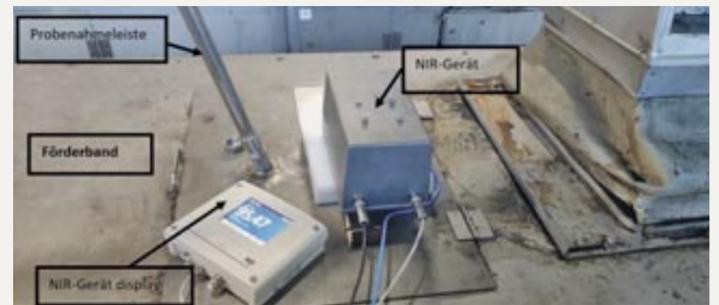
Abbildung 3: Test des NIR-Gerätes online auf einem Förderband.
