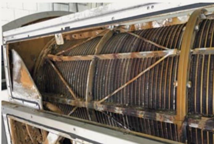
Abbildung 1: Siebkorb der Schneckenpresse vor der Reinigung / Entkalkung.
