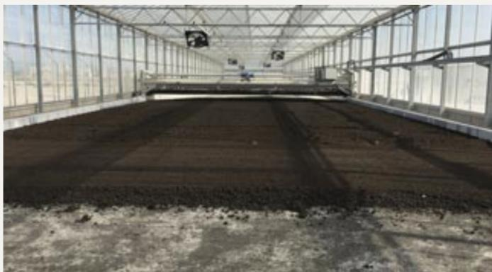
Der SOLSTICE® 11 in Askar (Bahrain) bei der Trocknung von Klärschlamm.
