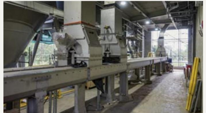
HUBER-Förderlösung für getrockneten Klärschlamm nach Bandrockneranlagen.
