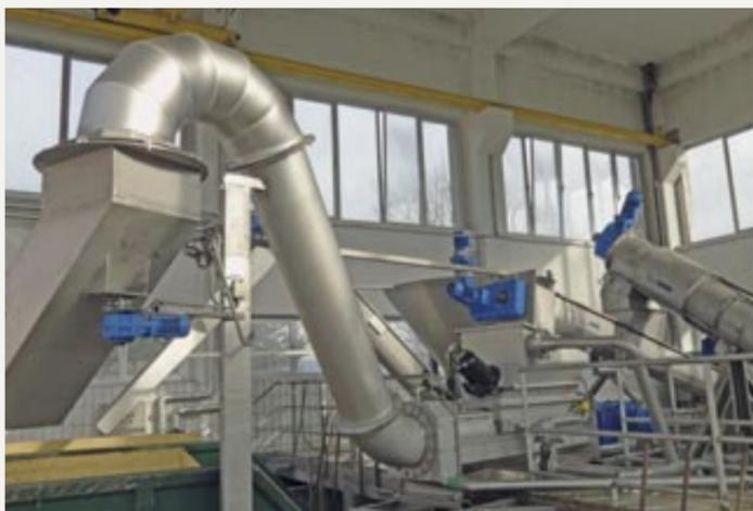
Abbildung 3: Einfaches Rutschenverteilsystem zur optimalen Containerbeschickung.
