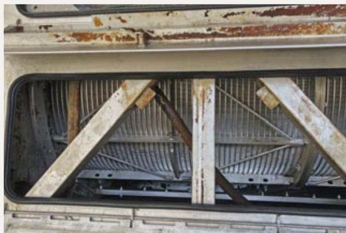
Abbildung 2: Siebkorb der Schneckenpresse nach der Reinigung / Entkalkung.
