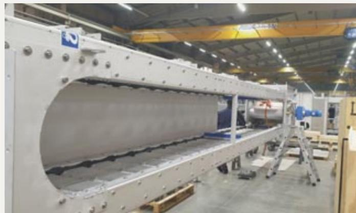
Abbildung 1: HUBER Bandrechen CenterMax® Star für Intake-Anwendung (Flusswassersiebung) für ein Projekt in der Papierindustrie.
