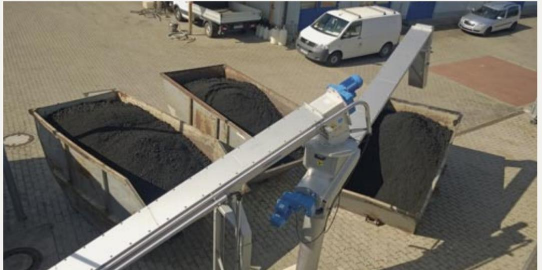
Lösung zur Containerbeschickung für entwässerten Schlamm von HUBER.
