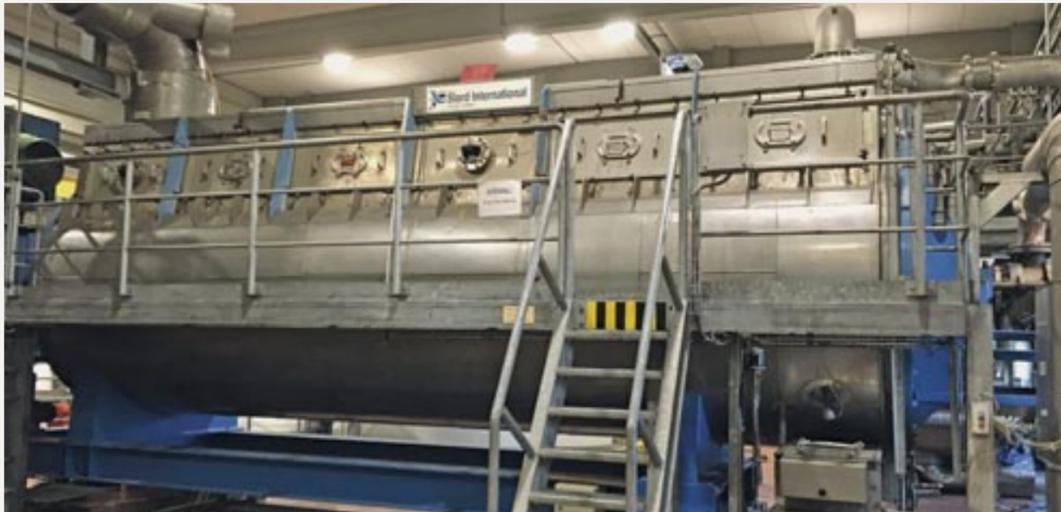
Abbildung 1: Scheibentrockner auf dem Klärwerk Hamburg-Köhlbrandhöft.
