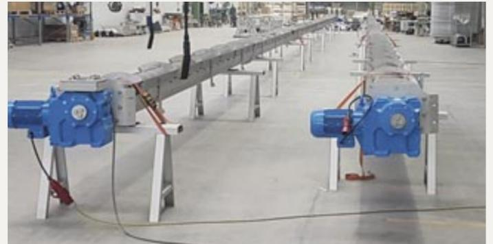
56 Meter Gesamtförderlänge: HUBER Trogförderschnecke Ro8 T, Bunkerentleerungssystem für HUBER Solarrockner, Maschinentest im Endzusammenbau.
