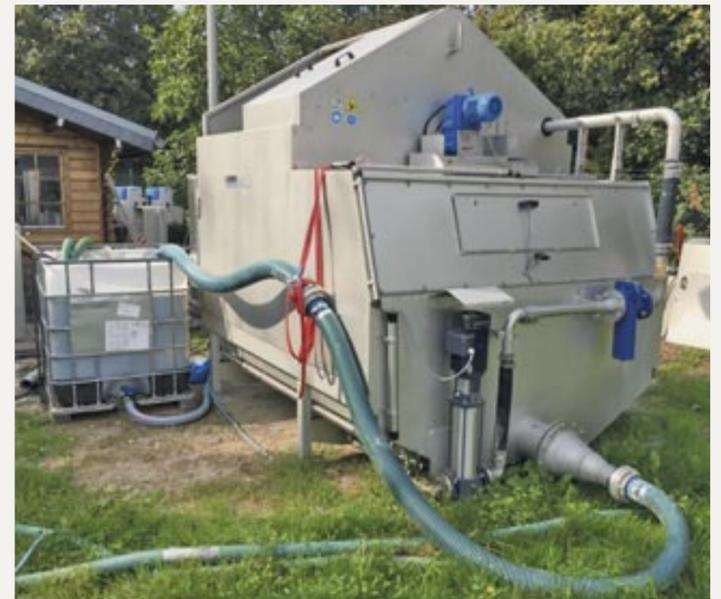
Abbildung 2: Vorführanlage HUBER Scheibenfilter RoDisc®: Mikrosiebung zum Schutz der vierten Reinigungsstufe.
