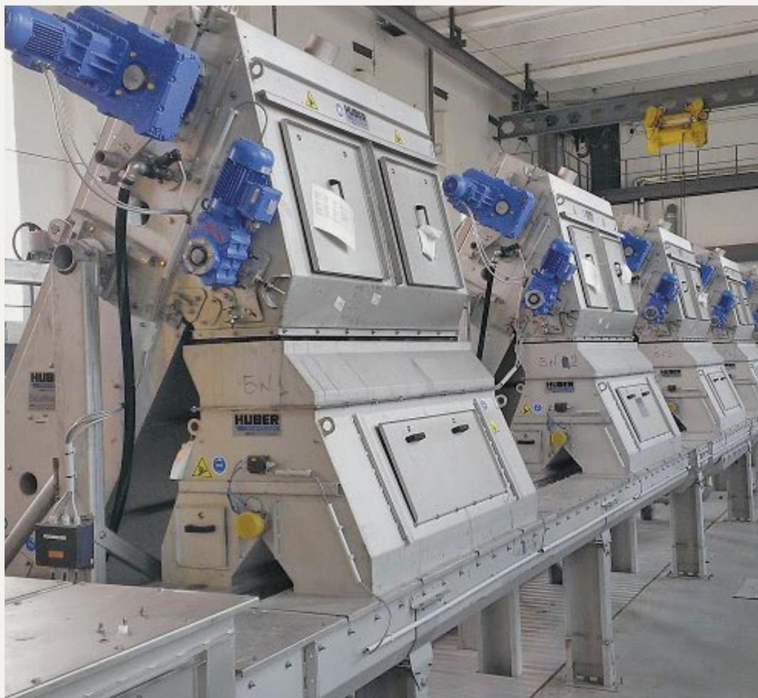
Abbildung 1: Klassische, vollredundante Transportlösung mit HUBER Trogförderschnecke Ro8 T.
