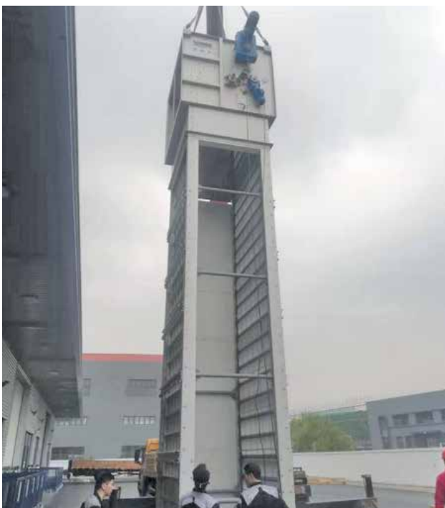
Für tiefe Gerinne mit hohen Wasserspiegeln für hohe Durchsatzleistungen.
