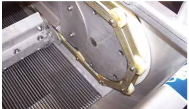
*Optional kann die untere Kettenumlenkung anstelle der bewährten Keramiklager über eine starre Kettenumlenkbahn erfolgen. Bei dieser Ausführung befinden sich keine Lager im Unterwasserbereich.*
