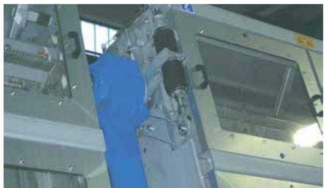
*Eine elektromechanische Überlastsicherung (Drehmomentwippe) sorgt zuverlässig dafür, dass bei Erreichen der voreingestellten Überlast bzw. bei Blockade der Arbeitsvorgang unterbrochen und gleichzeitig ein elektrisches Signal abgegeben wird. Aufgrund des Konstruktionsprinzips ist eine sehr gute Einstellbarkeit sowie eine kontinuierliche Überwachung gegeben.*
