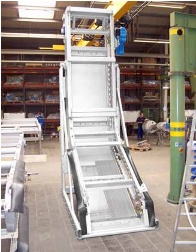
HUBER Harken-Umlaufrechen RakeMax® HF vor der Auslieferung im Werk zeigt deutlich den flachen und daher hydraulisch günstigen Siebabschnitt.
