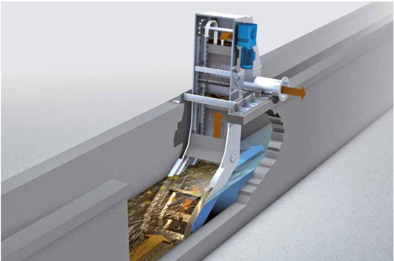
Die schematische Darstellung des HUBER Harken-Umlaufrechen RakeMax® HF verdeutlicht den Übergang vom flachen und daher hydraulisch günstigen Siebabschnitt mit anschließendem Übergang in den steilen Förderabschnitt.
