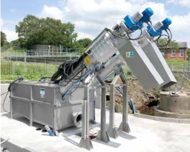
Zwei HUBER Siebschnecke ROTAMAT® Ro9 in einem Behälter. Ausgeführt für Maschinenredundanz.
