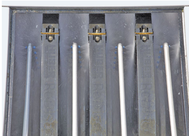
Zpětné promývání filtračních disků filtratem – není nutná žádná externí promývací voda.
