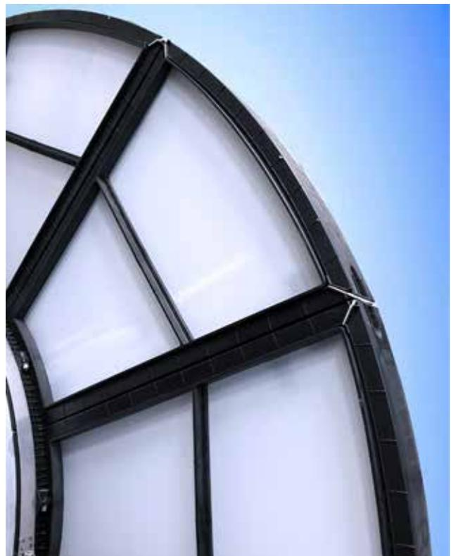
*Scheibenförmiges Siebelement mit Maschenweite kleiner als 20 µm.*
