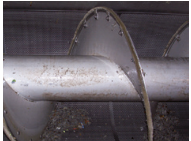
Siebgutschonende Zwangsreinigung der radialen Siebfläche.
