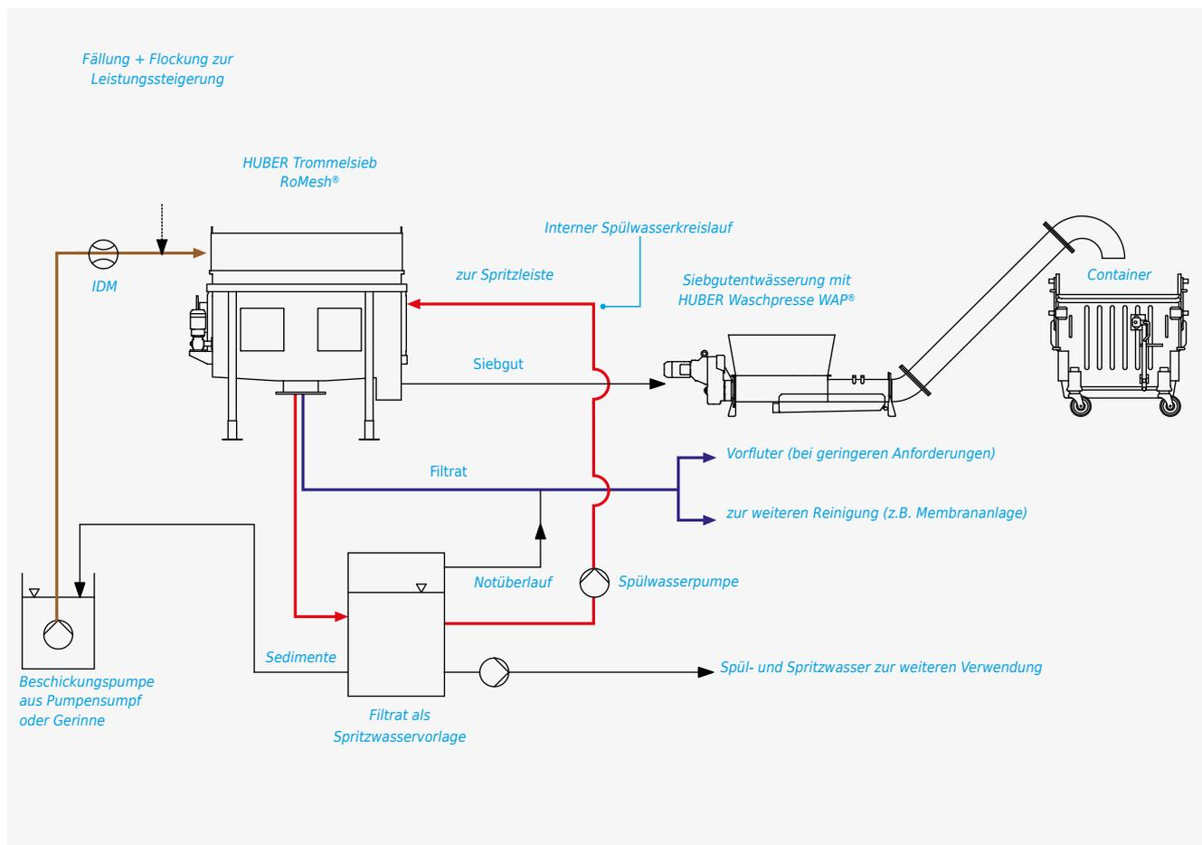
Fließbild einer mechanischen Abwasserreinigung mittels HUBER Trommelsieb RoMesh®.
