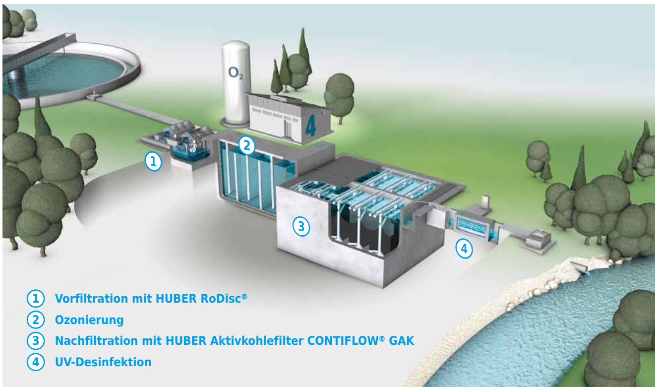
Prinzip HUBER Aktivkohlefilter CONTIFLOW® GAK.
