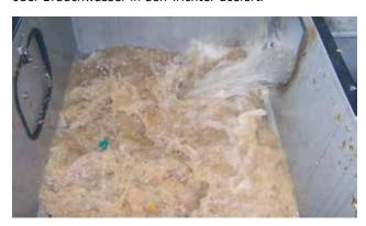
Das Pumpenlaufrad erzeugt hohe Turbulenzen im Waschtank während des Waschgangs.
