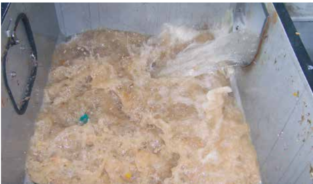
Das Pumpenlaufrad erzeugt hohe Turbulenzen im Waschtank während des Waschgangs.
