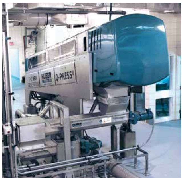
HUBER Schneckenpresse Q-Press® 800.2 für 20 m 3 /h.
