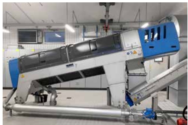
Faulschlamm-entwässerung bis zu 30 % TR.
