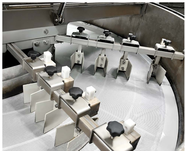
Verschleißarmes Siebelement aus Edelstahl.
