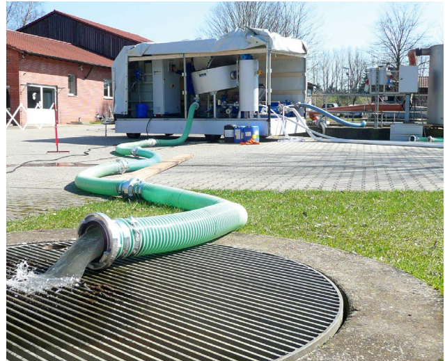
Mobiler HUBER Scheibeneindicker S-DISC im PKW-Anhänger; im Vordergrund fließt klares Filtrat ab.
