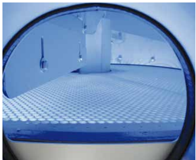
Verschleißarmes Siebgewebe aus Edelstahl.
