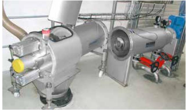
Teilbar ausgeführtes Gehäuse.
