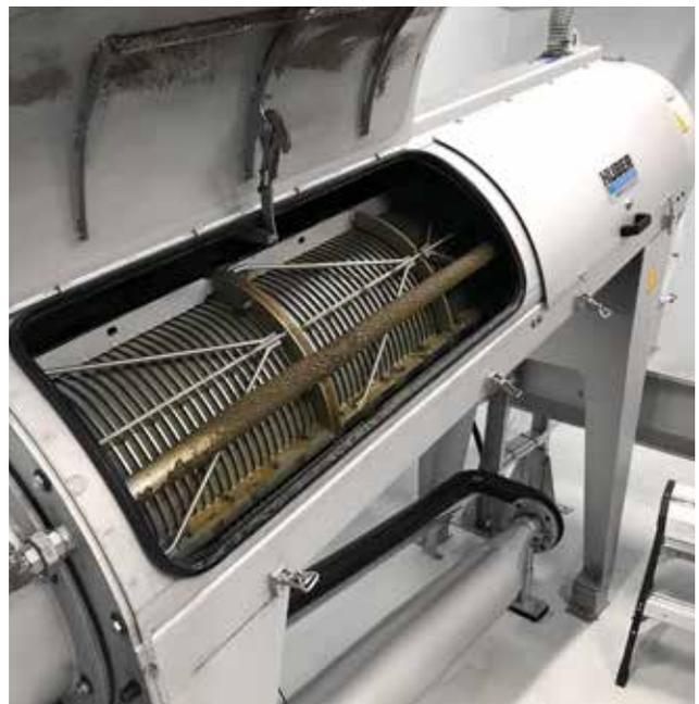
*HUBER Schneckenpresse zur Entwässerung von Restschlämmen aus OnShore-Fischfarmen (Lachsproduktion) – Reduktion der Entsorgungskosten.*
