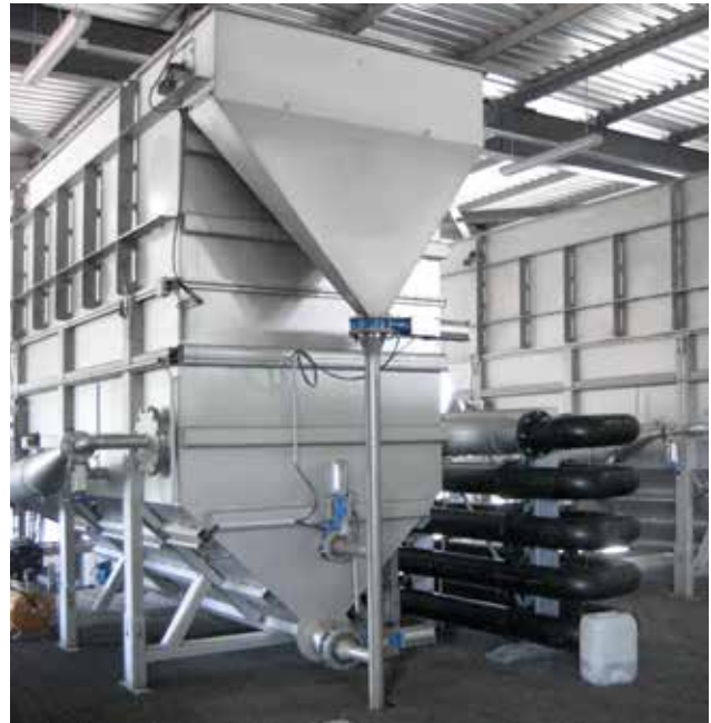
HUBER Druckentspannungsflotationen mit chemischer Stufe zur Belebtschlammabtrennung – die Lösung zur Entlastung überfrachteter biologischer Behandlungsanlagen.
