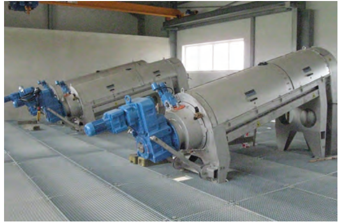
HUBER Schneckenpressen zur Schlammbehandlung – beste Entsorgungskosten.
