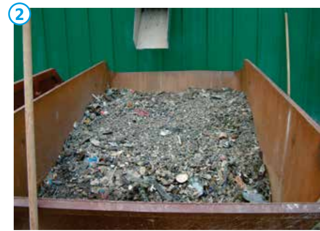
Absiebung der ausgewaschenen Grobstoffe > 10 mm mit HUBER Waschtrommel RoSF9.
