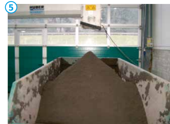
Flotat- und Sedimentschlammwässerung HUBER Schneckenpresse S-PRESS TR > 50 %.
