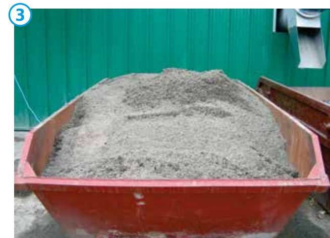
Sand aus HUBER Coanda Sandwaschanlage RoSF4 TR > 90 % und GV < 3 %.
