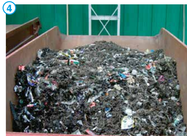
Absiebung HUBER Siebanlage ROTAMAT® Ro2 Organik TR > 30 % (> 1 mm).
