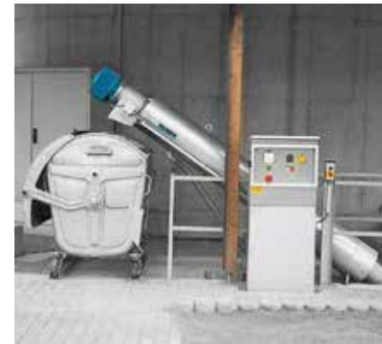
HUBER Siebschnecke ROTAMAT® Ro9 die preisgünstige Lösung für kleine Abwassermengen.
