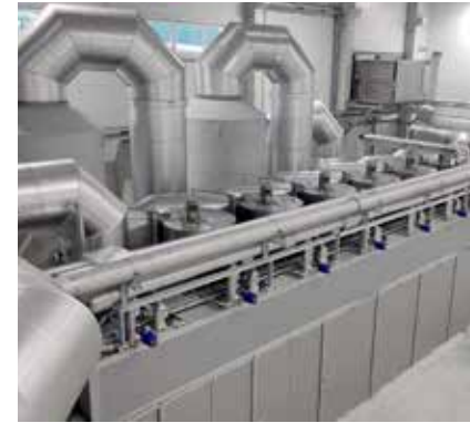
Schlamm Trocknung in der Industrie mit HUBER Bandrockner BT.
