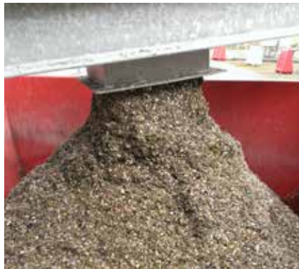
Abgetrennter Kunststoff aus Gärrestsiegung.
