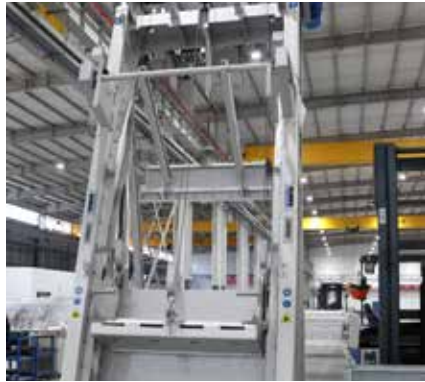
Kopfteil des HUBER Schallengreiferrechens TrashLift in der HUBER Fertigung, Länge des gesamten Rechens 15 m.
