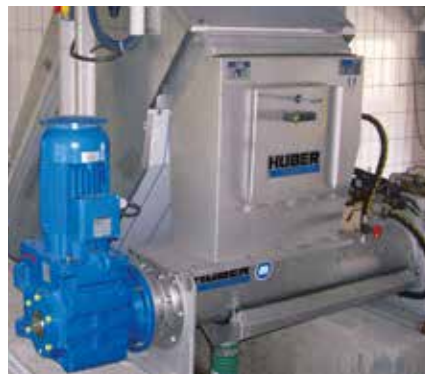
HUBER Waschpresse WAP® installiert nach einem HUBER Stufenrechen STEP SCREEN®.
