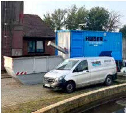
HUBER Schneckenpresse Q-PRESS® als mobile Einheit für Versuche vor Ort.
