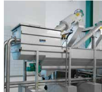
HUBER Fäkalannahmestation ROTAMAT® Ro3.3: eine weltweit bewährte Anlage.
