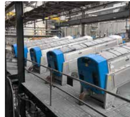
Schlammentwässerung mit HUBER Schneckenpresse Q-PRESS® 800.2.
