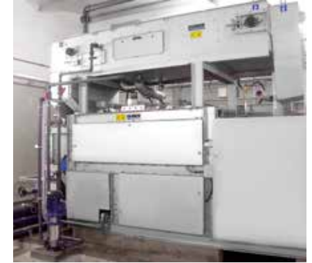
HUBER Bogenpresse B-PRESS: kombinierbar mit dem HUBER Bandeindicker DrainBelt für hohe Durchsätze.
