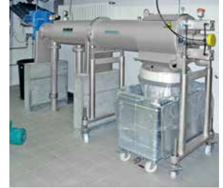
HUBER Fremdstoffabscheider STRAINPRESS® – Kontinuierliche Fremdstoffabscheidung unter Druck.
