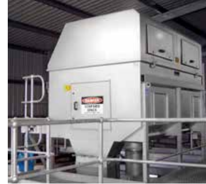
HUBER Trommelsieb RoMesh® zur Mikrosiebung.
