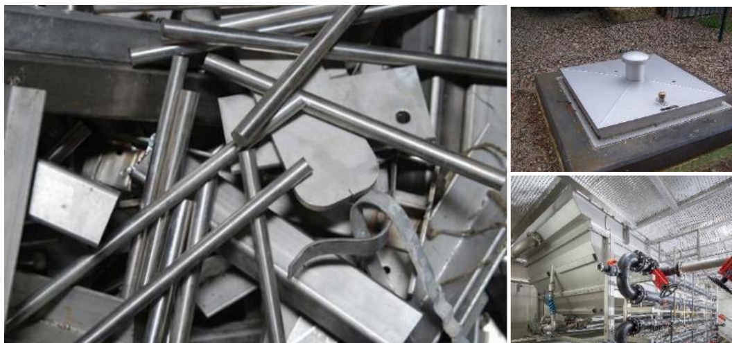
Abbildung 24: Ein großer Anteil unser Abfälle besteht aus Edelstahl. Die Reduzierung des Verschnitts ist bei der Verarbeitung hochwertiger Materialien Voraussetzung für eine kostenoptimierte und ressourcenschonende Produktion. HUBER verschachtelt die aus Edelstahl zu fertigenden Teile deshalb auftragsübergreifend mit modernster CAM-Software. Der bei der Produktion anfallende Edelstahlverschnitt wird zu 100% dem Recycling zugeführt.
