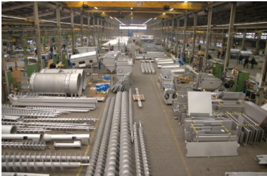
Abbildung 29: Die HUBER SE verarbeitet jährlich ca. 4.500 t Edelstahl und produziert daraus verschiedene Produkte für die Bereiche der Wasserver- und Abwasserentsorgung.
