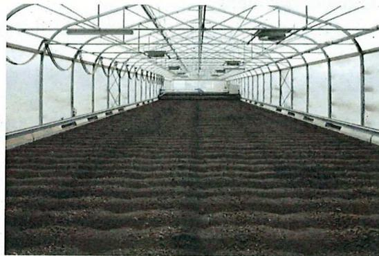
Abbildung 16: Beim solaren-regenerativen Trocknungsverfahren nutzt HUBER die Sonnenenergie, um Klärschlamm zu trocknen. Fossile Energieträger können somit eingespart werden.
