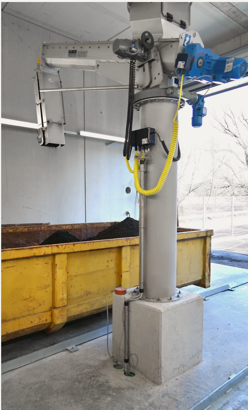
HUBER Trogförderschnecke Containerverteiler Ro8 TC mit Höhenstandmessung und motorischen Schwenkmechanismen.
