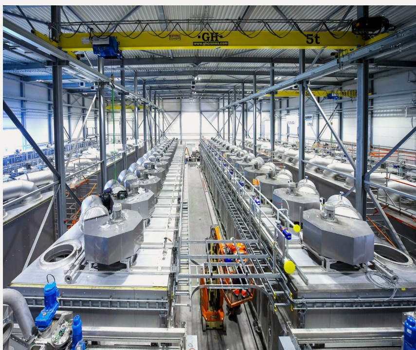
6 HUBER Bandtrockner BT zur thermischen Verwertung von ca. 232.000 Tonnen Klärschlamm pro Jahr.
