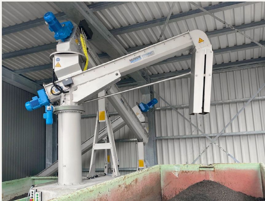
Automatische Förder-technik mit Schlamm-Verteilung inkl. Vollfüllkontrolle und Höhenstandüberwachung.
