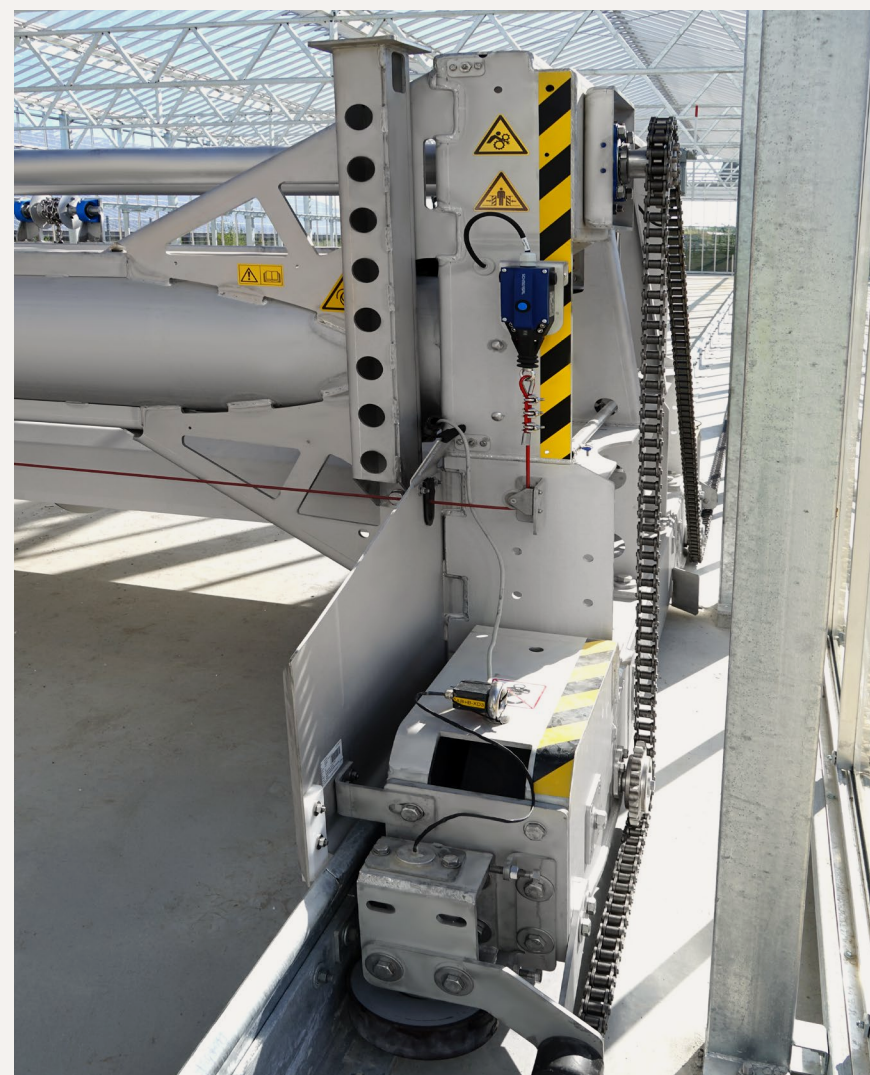
Der HUBER Schlammwender SOLSTICE® FloorRunner verfährt ebenerdig und benötigt kein Betonfundament mehr.
