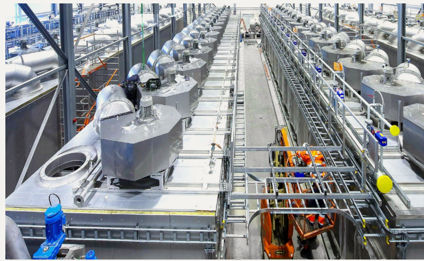
6 HUBER Bandrockner BT zur thermischen Verwertung von ca. 232.000 Tonnen Klärschlamm pro Jahr.
