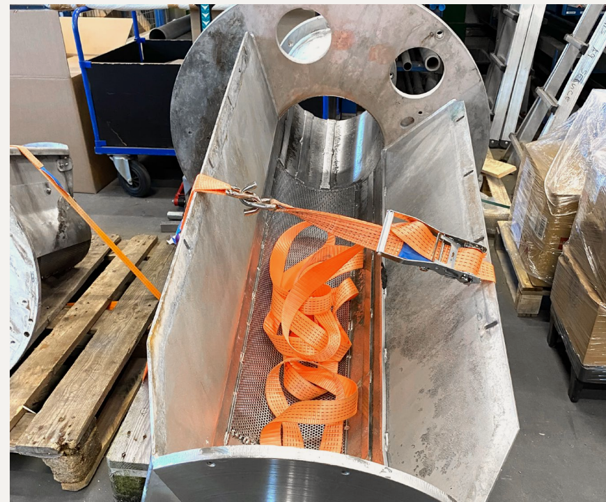
Vorher-Zustand: Das Steigrohr der HUBER Siebanlage ROTAMAT® Ro2 vor der professionellen Aufarbeitung in der HUBER Werksreparatur.
