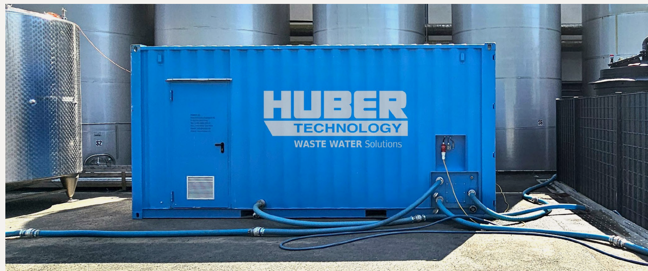
HUBER Druckentspannungsflotation HDF S2 bei der Pilotierung.
