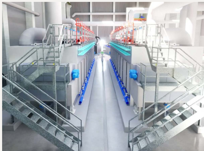
Die 2 HUBER Bandrockner BT 22 in Roeselare – geplant und real.
