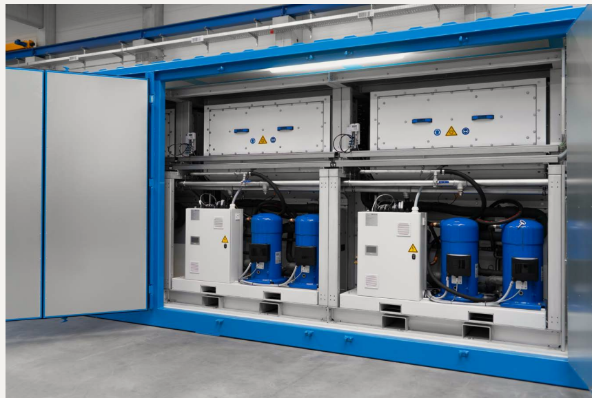
Das Innenleben des Containers: Je nach Bedarf können zwischen eins bis fünf Trocknungsmodul eingesetzt werden.
