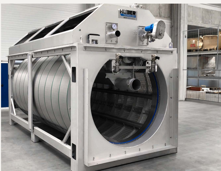
HUBER Trommelsieb LIQUID, gefertigt in der HUBER-Produktion in Berching.
