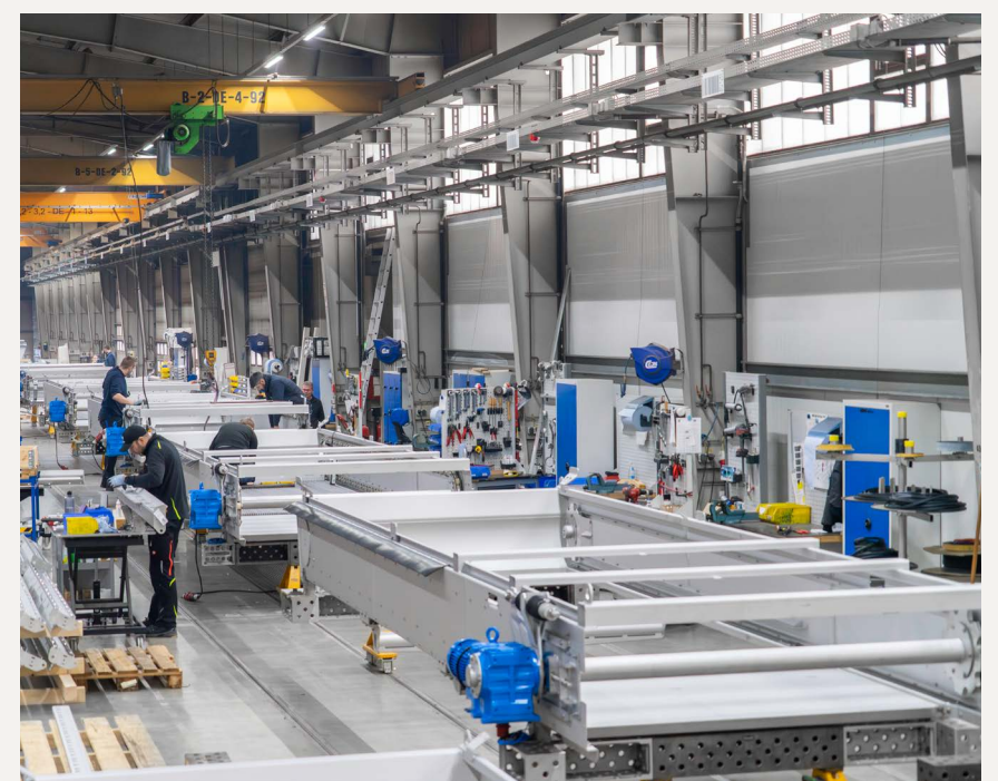
Linienfertigung der HUBER Harken-Umlaufrechen RakeMax® in der Produktion am Unternehmenssitz Berching.
