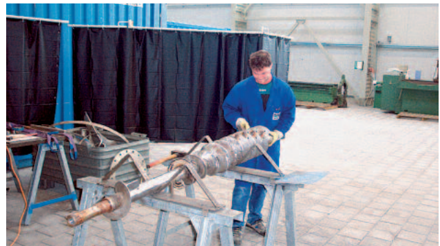
Komplette Überarbeitung einer verbrauchten Schneckenwelle
