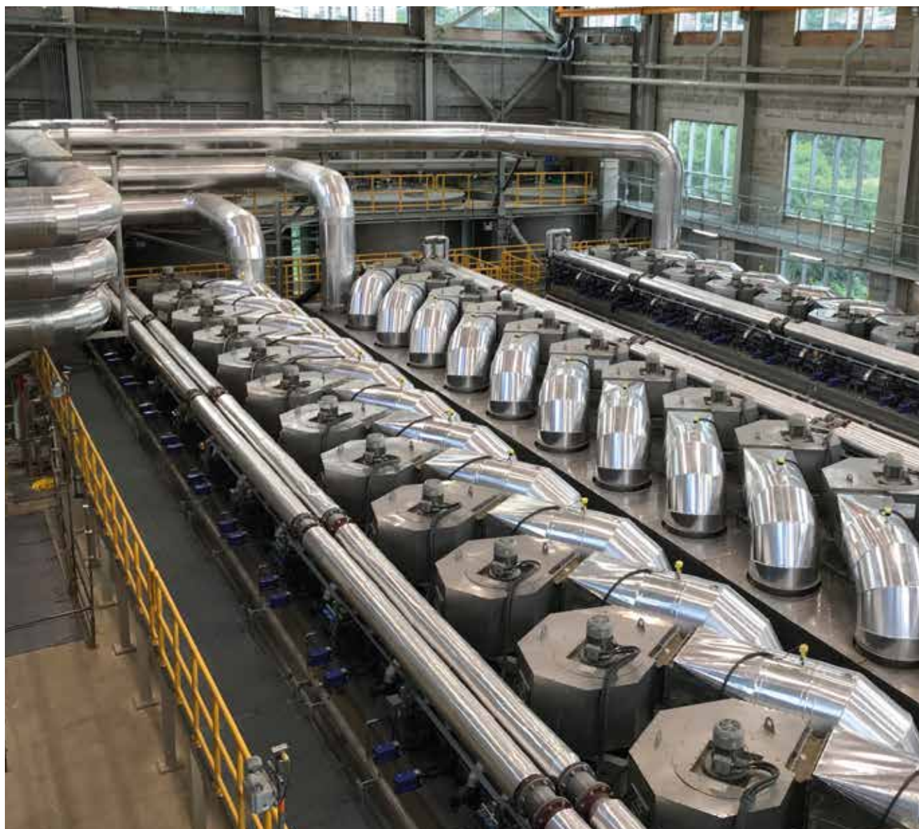
Design multilinha do secador de esteira BT HUBER para grandes projetos.
