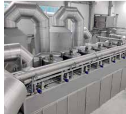
Secagem do lodo na indústria com o secador de esteira BT HUBER.
