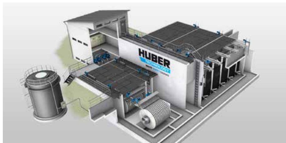
Filtragem de floculação com filtro de meio de tecido em pilha Rotafilt® HUBER e remoção a jusante de micropoluentes com filtro de carbono ativado CONTIFLOW® GAC HUBER.
