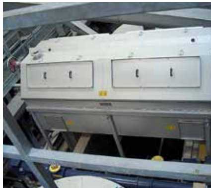
Tela de tambor RoMesh® para a remoção do material fino e mais fino.
