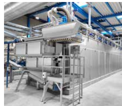
Secador de esteira BT HUBER para secagem de lodo de esgoto até > 90% de DR.
