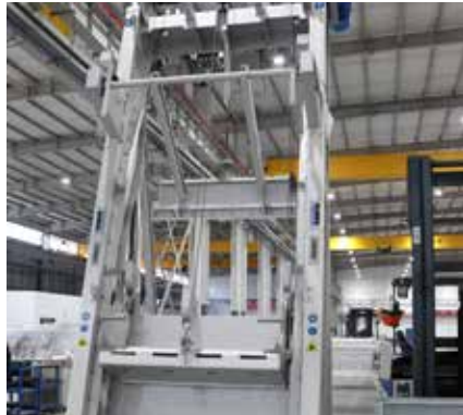
Seção principal da grade com garras TrashLift na produção da HUBER, comprimento de toda a tela 15 m.
