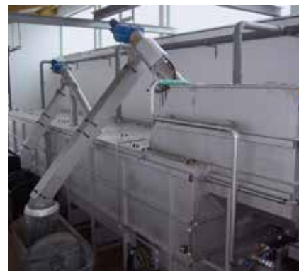
Tratamento mecânico completo de águas residuais mecânicas em uma unidade única e compacta.
