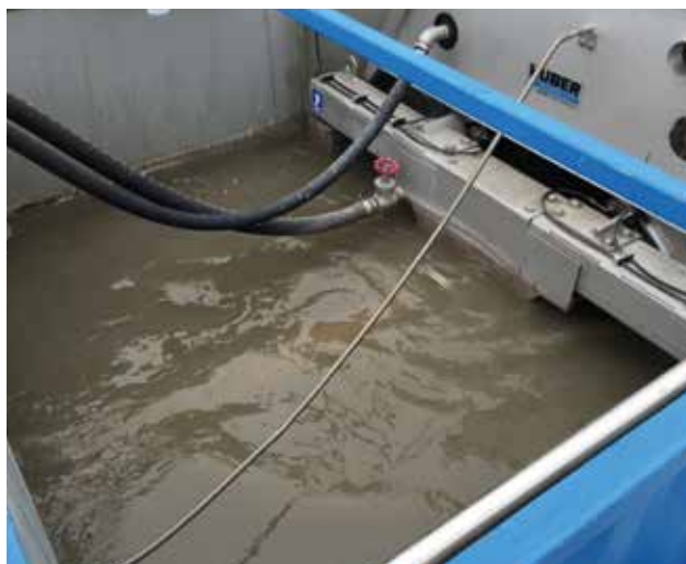
Peneira de tambor LIQUID HUBER para máxima eficiência de separação e, ao mesmo tempo, baixas perdas de pressão.
