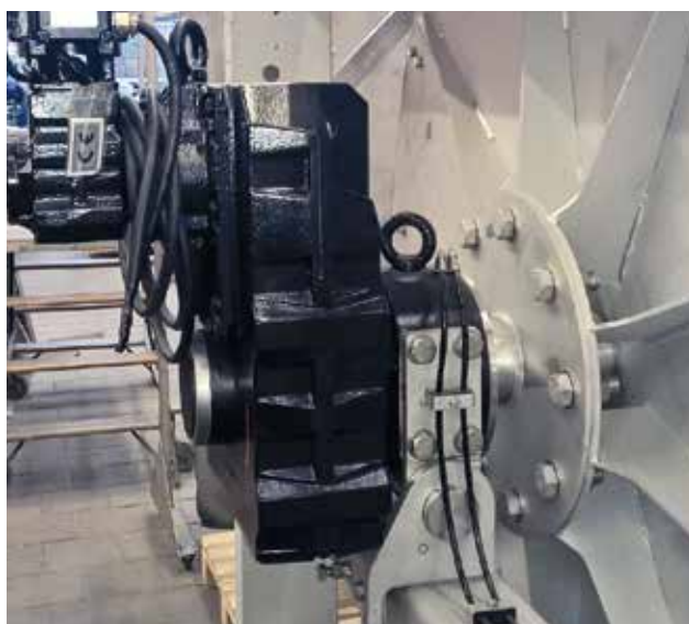
Acionamento por corrente, de baixa manutenção, na peneira de tambor LIQUID HUBER.
