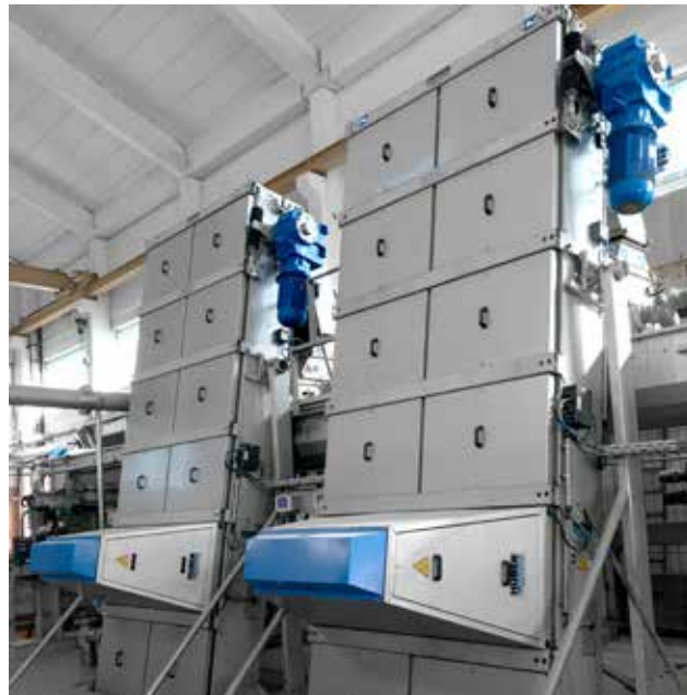
Duas unidades de grade multirrastelos RakeMax® HUBER equipadas com o sistema de detecção Safety Vision HUBER. Ao detectar perturbações no peneirado, o Safety Vision evita danos à peneira e às máquinas a jusante.
