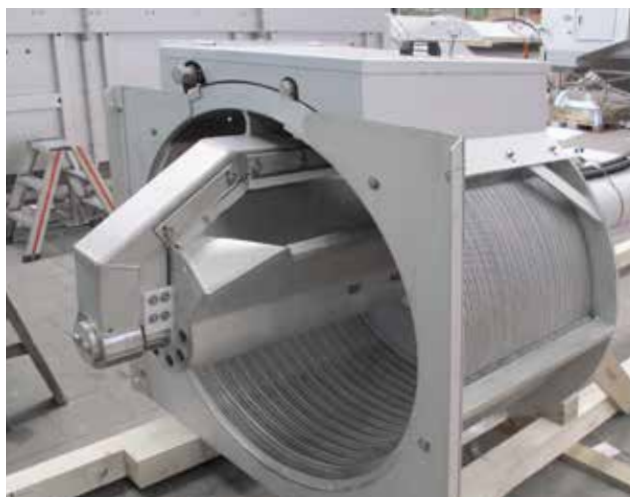
Peneira fina HUBER ROTAMAT® Ro1 com tampa de cesto de peneira para evitar a saída de água projetada.
