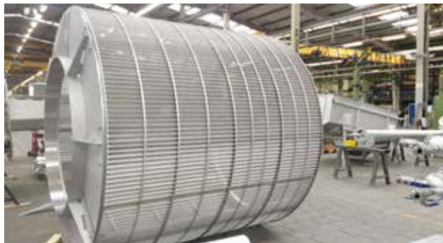
Cesto de peneira ROTAMAT® STAR, diâmetro de 2.600 mm, perfuração de 1 mm, tratado com ácido em banho de decapagem e passivado.
