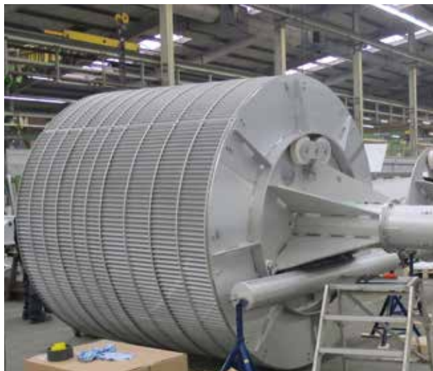
Peneira de placa perfurada ROTAMAT® STAR HUBER, diâmetro de 2.600 mm, perfuração de 1 mm.
