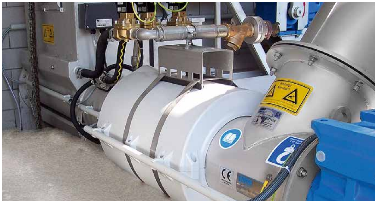
Compactador do peneirado Ro7 HUBER – design compacto, com lavagem opcional do peneirado.
