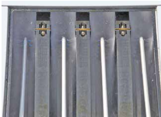
Retrolavagem dos discos do filtro com filtrado – sem necessidade de água de lavagem externa.
