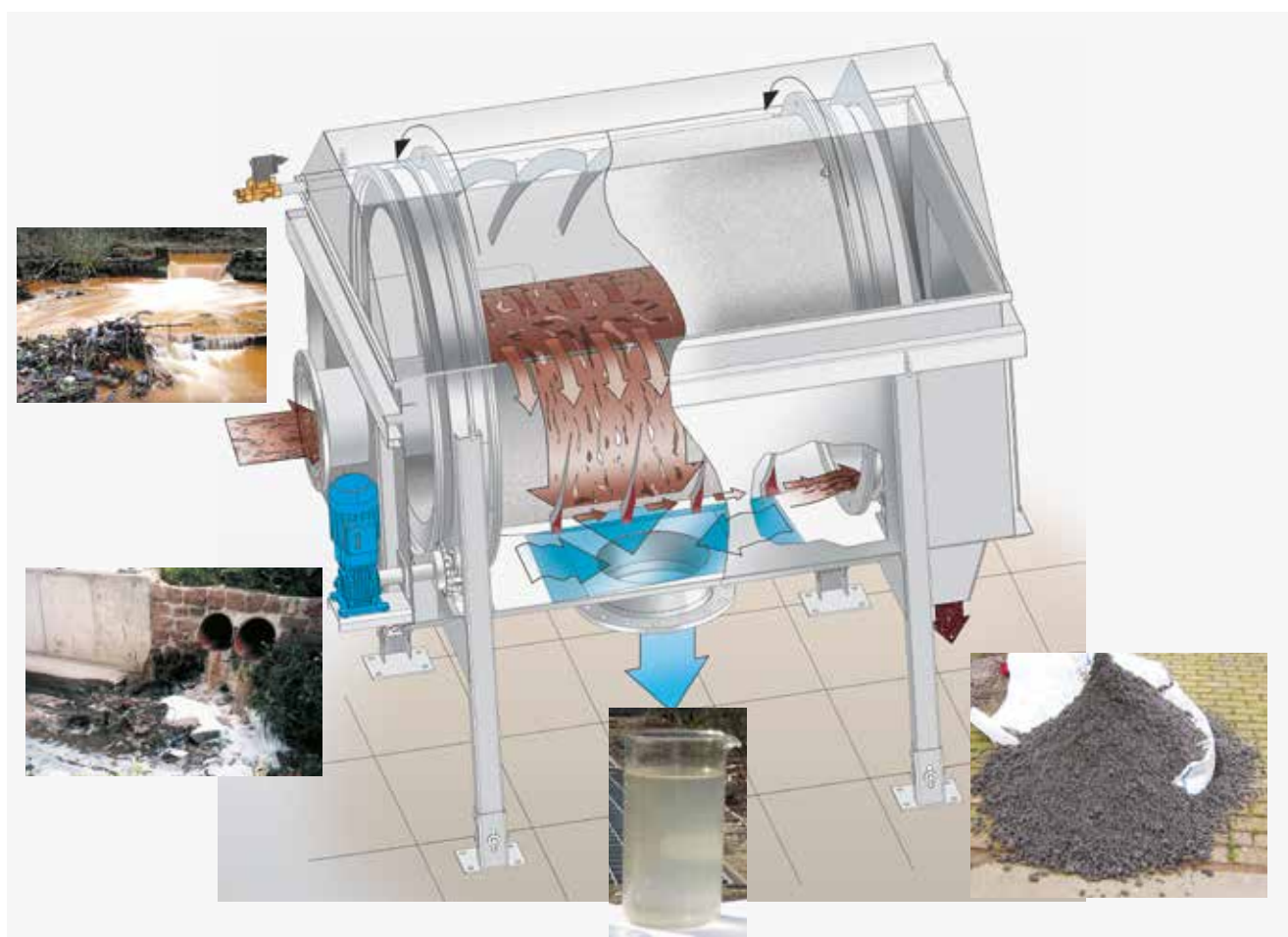
Desenho esquemático da peneira de tambor RoMesh® HUBER.
