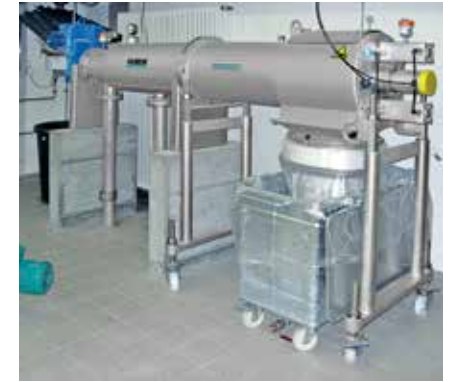
HUBER síťový separátor STRAINPRESS® – průběžná separace hrubých nečistot.
