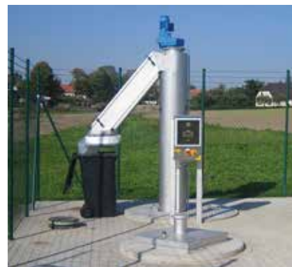
HUBER čištění v kanálových šachtách ROTAMAT® RoK4 s ohřevem pro venkovní instalaci.
