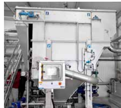
HUBER zařízení na flotaci rozpuštěným vzduchem HDF pro interní recyklaci vody.
