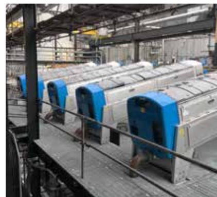
Odvodnění kalu pomocí šnekového odvodňovače HUBER Screw Press Q-PRESS® 800.2.
