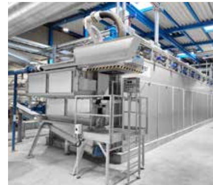
Pásová sušička čistírenských kalů HUBER BT pro sušení čistírenských kalů až na >90 % sušiny.
