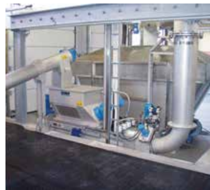
HUBER lis na shrabky s intenzivním propíráním WAP® SL zaručuje maximální stupeň propírky.
