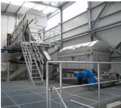
Kompletní systém pro zpracování písku z kanalizace a silničního odpadu.
