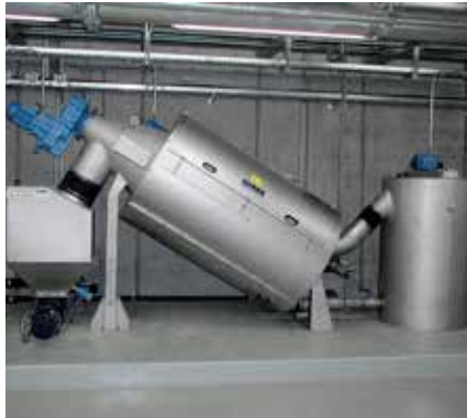
Extrémně pevný: HUBER šnekový zahušťovač kalu S-DRUM.
