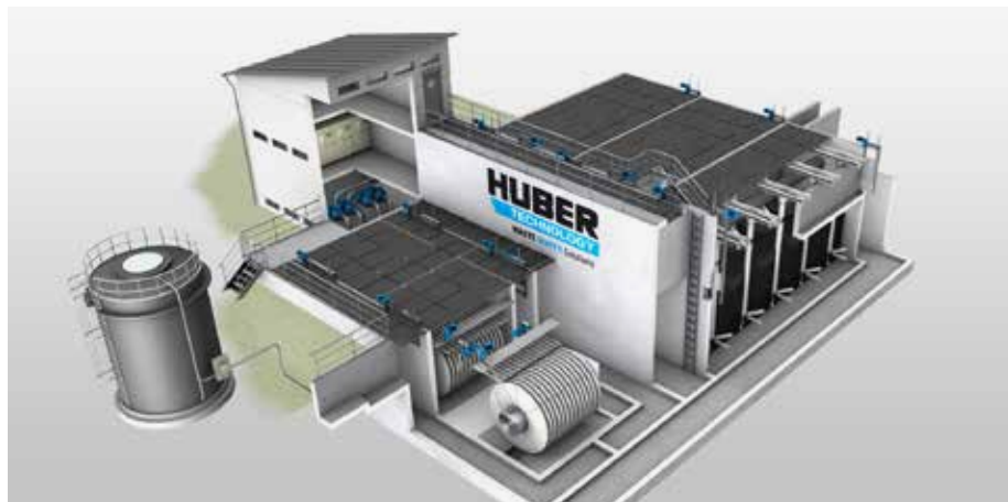
Flokulační filtrace s filtrem HUBER Pile Cloth Media Filter Rotafilt® a následné odstraňování mikropolutantů filtrem s aktivním uhlím HUBER CONTIFLOW® GAC.
