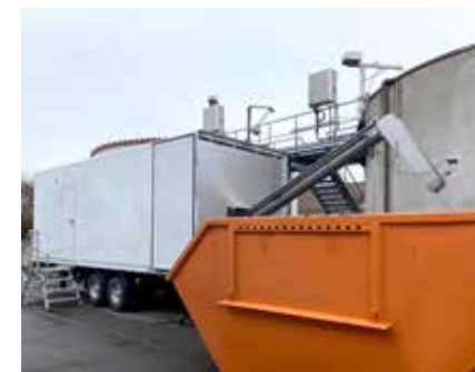
Kontejnerové systémy k odvodňování kalů – k pronájmu nebo jako trvalé instalace.
