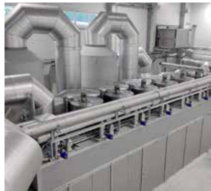
Vysoušení kalu v průmyslu pomocí pásové sušárny BT HUBER.
