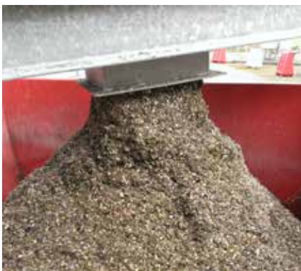
Separace plastů cezením fermentačních zbytků.
