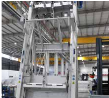
Čelní část zařízení HUBER Grab Screen TrashLift ve výrobě HUBER, celková délka síta: 15 m.
