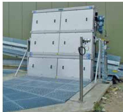
HUBER hrubé česle RakeMax® pro cezení říční vody v papírenském průmyslu.
