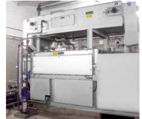
HUBER sítopásový lis B-PRESS lze kombinovat s jednotkou HUBER pásového zahušťovače kalu pro další zvýšení kapacity.
