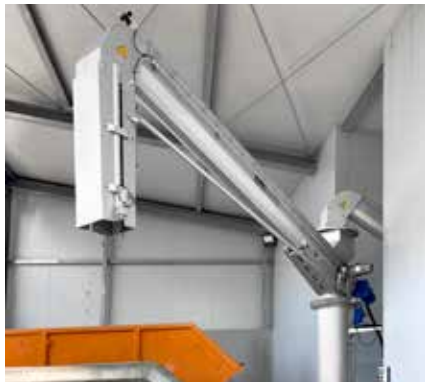
Rotační distribuční šnekový dopravník Ro8 TC pro odvodněný kal.
